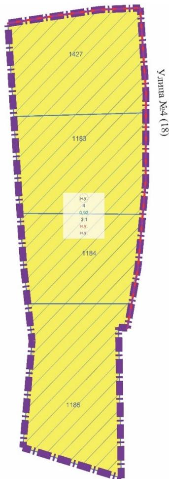
Фрагмент чертежа планировки территории с отображением красных линий, границ элементов планировочной структуры и зон планируемого размещения объектов капитального строительства
