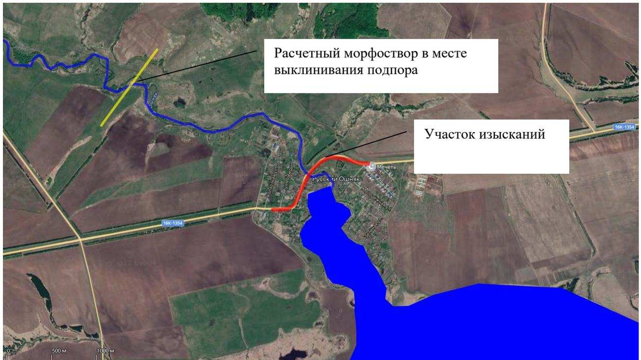
Рисунок 7. Схема расположения расчетного морфоствора для определения наивысших уровней воды вне зоны распространения подпора Куйбышевского водохранилища
