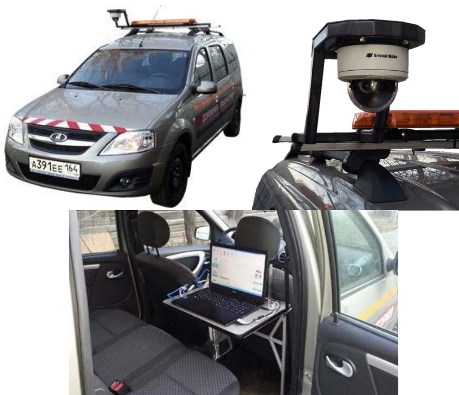
4 нче рәсем - Үлчәү комплексы - «LADA Largus» автомобиле базасында КП-514СМП күчмә юл лабораториясе
