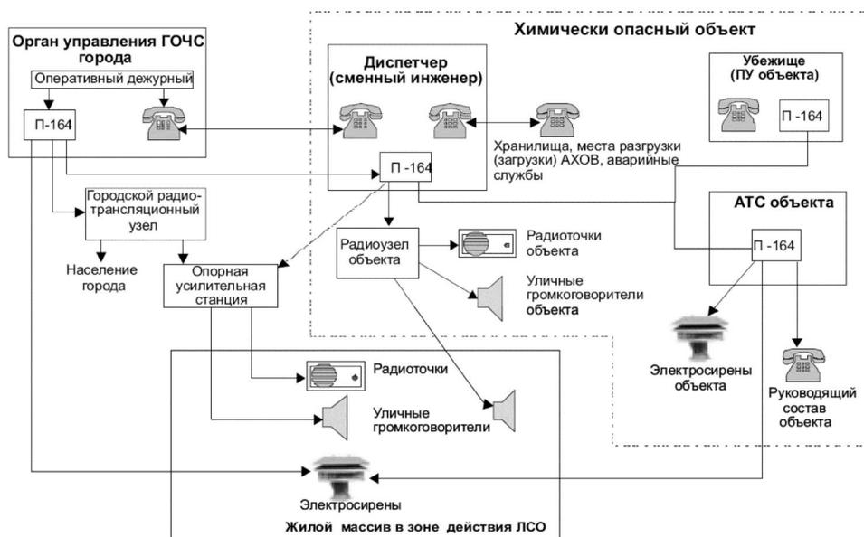
Рис. 4. Схема построения ЛСО химически-опасного объекта
