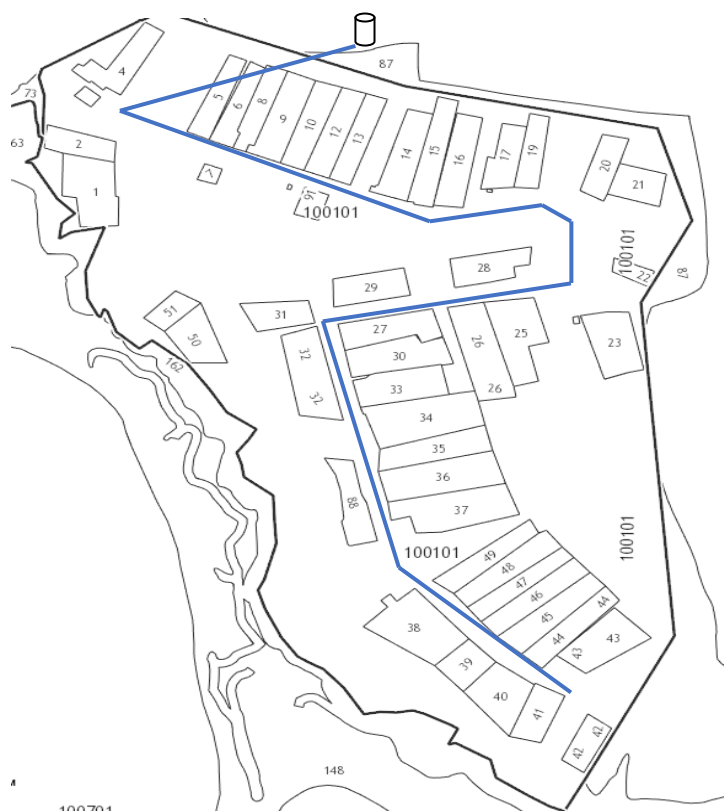
Рисунок 11. Схема расположения существующих водозаборных сооружений и водопроводной сети на территории села Черкасово
