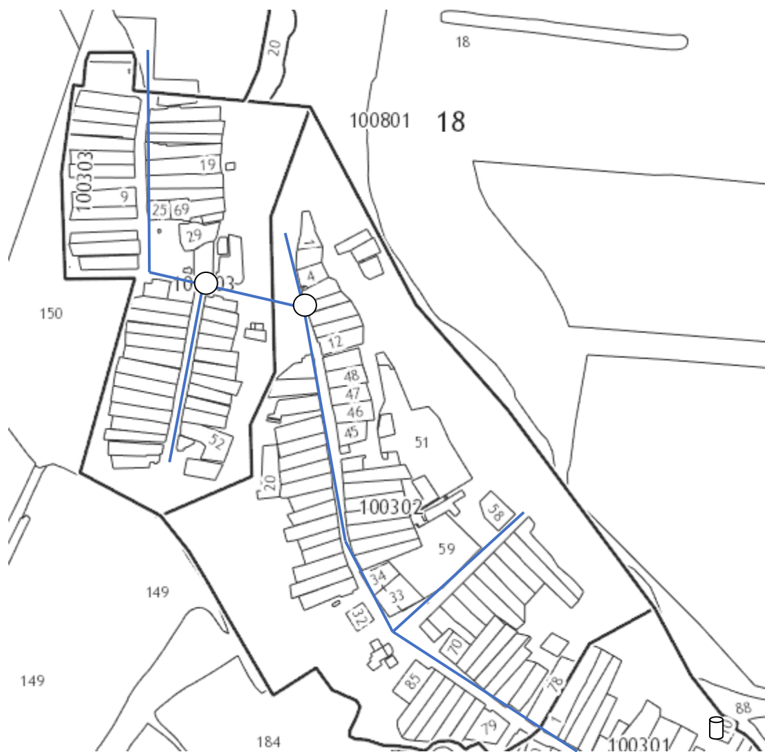
Рисунок 7. Схема расположения существующих водозаборных сооружений и водопроводной сети на территории села Старый Куклюк
