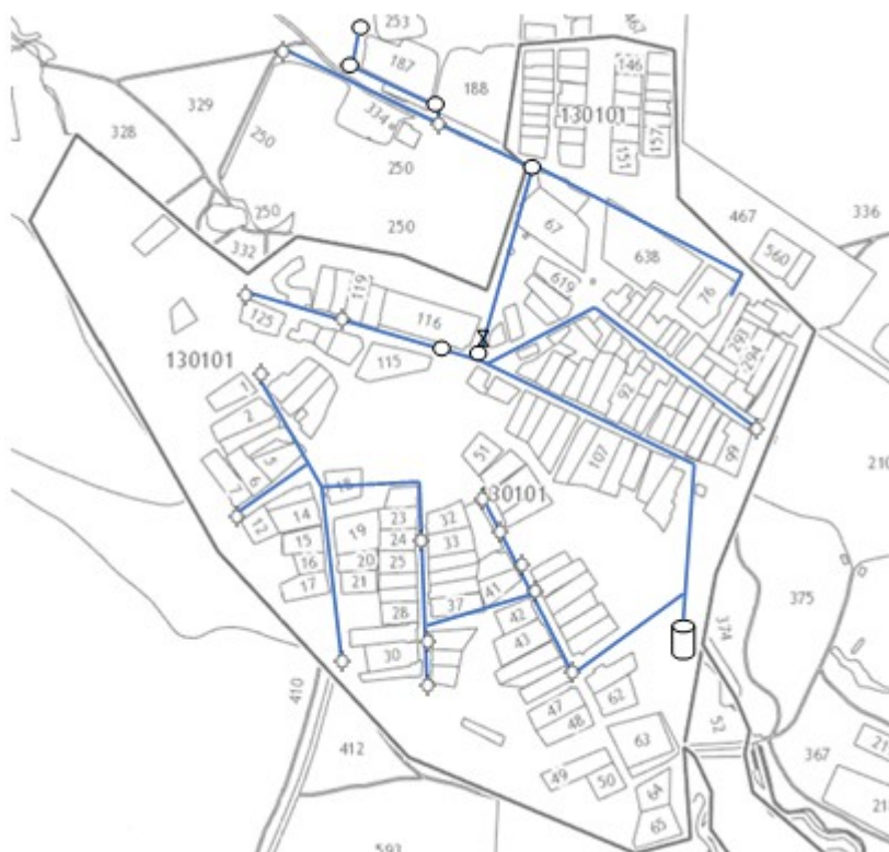
Рисунок 12. Схема расположения существующих водозаборных сооружений и водопроводной сети на территории села Костенево.
