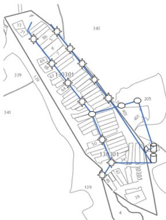
Рисунок 14. Схема расположения существующих водозаборных сооружений и водопроводной сети на территории деревни Казылы.
