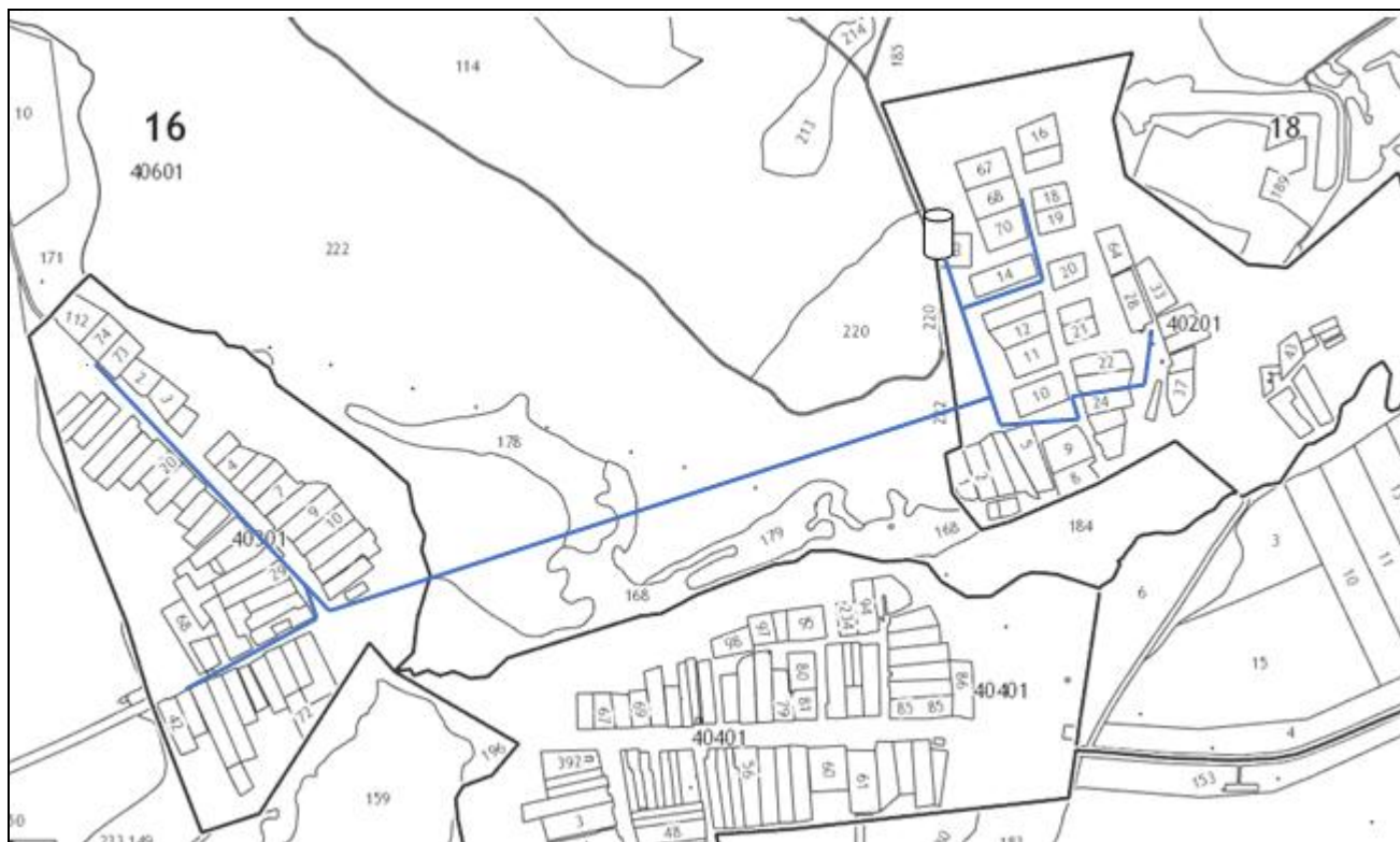
Рисунок 9. Схема расположения существующих водозаборных сооружений и водопроводной сети на территории села Б. Армалы.
