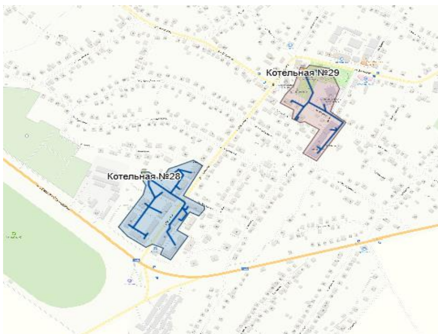
Рисунок 8 – Зоны теплоснабжения Котельной №28, Котельной №29
