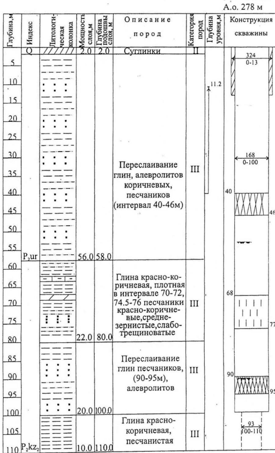
Геолого-технический разрез по скважине №26Д о/л "Дружба"
