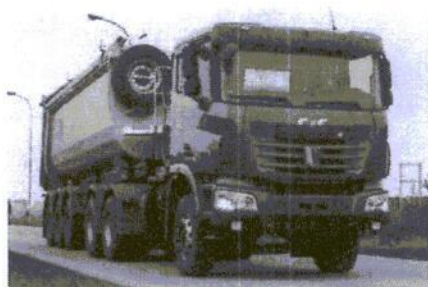
Седельный газовый тягач 6×4 С&С. Модель N332Т (на сжиженном природном газе)
