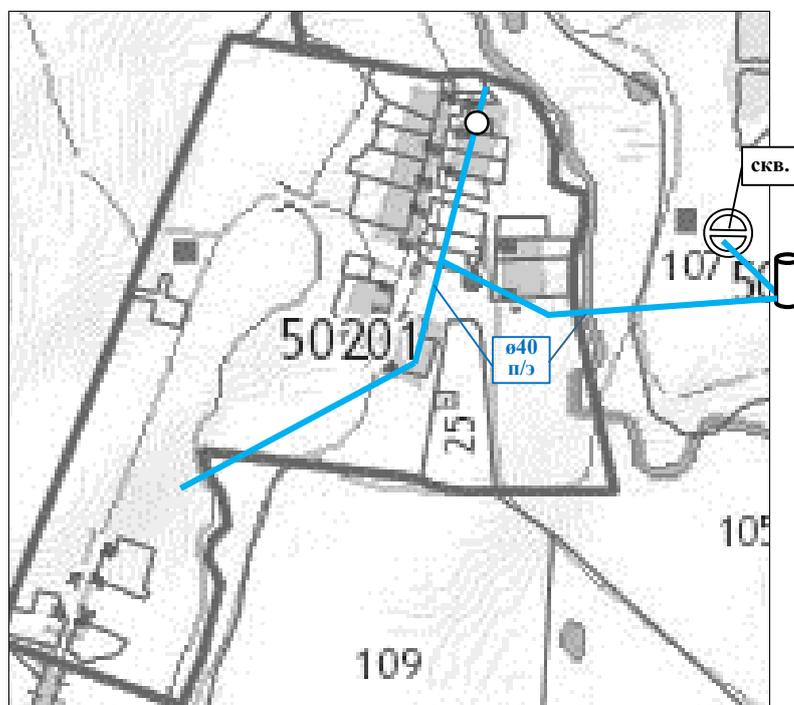
Рисунок 8. Схема расположения существующих водозаборных сооружений и водопроводной сети на территории д. Сосновый Юраш.
