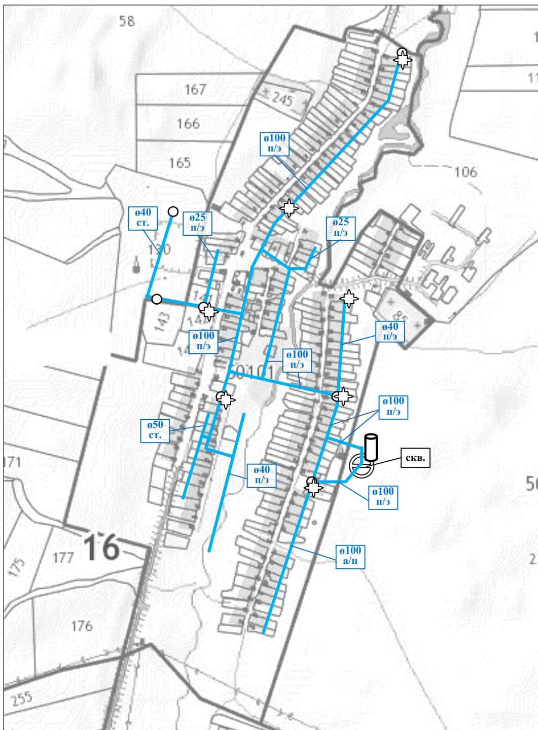
Рисунок 6. Схема расположения существующих водозаборных сооружений и водопроводной сети на территории села Старый Юраш.
