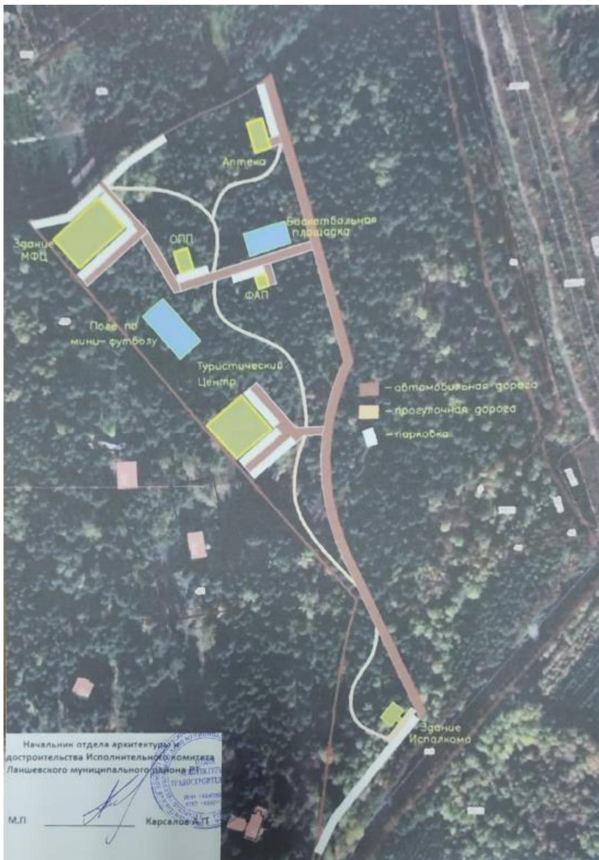
Схема размещения объектов капитального строительства и сопутствующих сооружений на территории запланированной под размещение реабилитационно-бальнеологический центра
