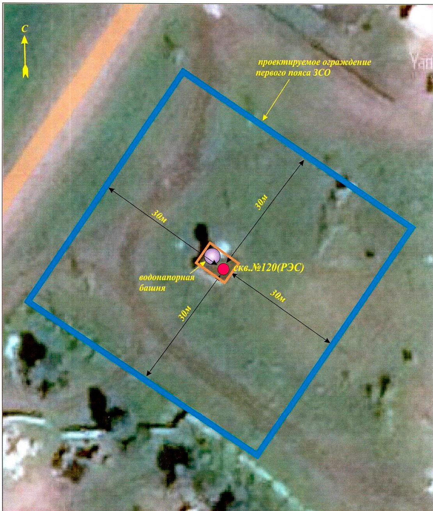
Рис. 6. План-схема проектируемого обустройства первого пояса ЗСО водозаборной скважины №120 (РЭС)
