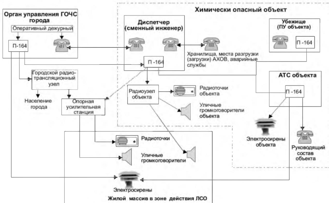
Рисунок 3.11.6.2. Примерная схема построения ЛСО на примере химически опасного объекта
