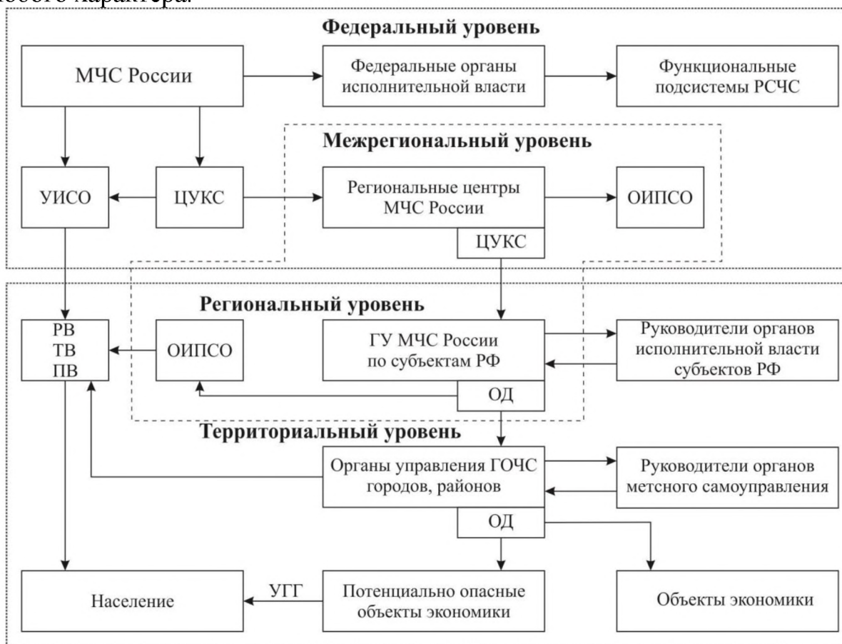
Рисунок 3.10.3.1. Схема организации информирования населения о прогнозируемых и возникших чрезвычайных ситуациях и пожарах.
