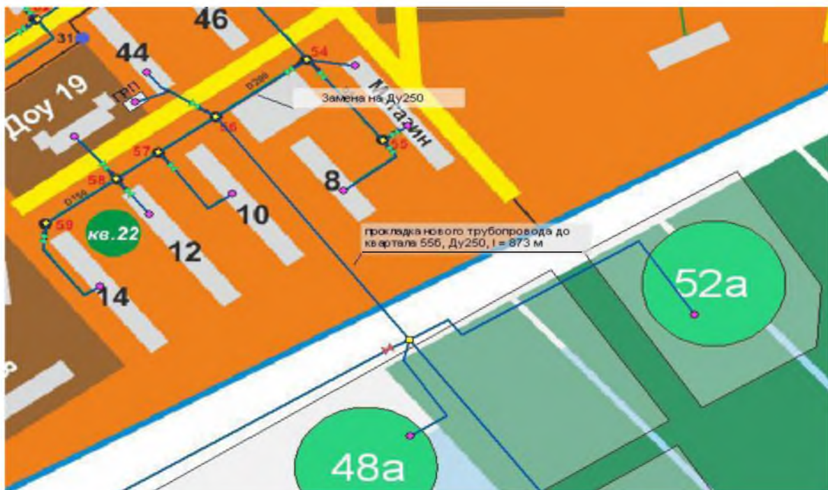
Рисунок 4. Замена существующего участка тр-да и прокладка нового тр-да в направлении квартала 55б
