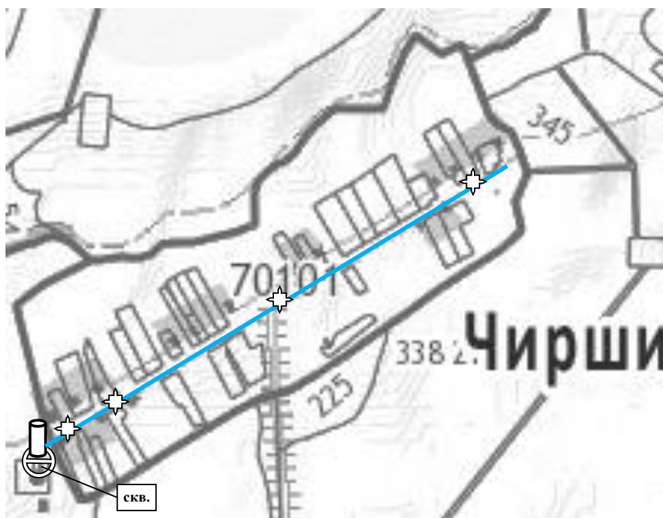
Рисунок 10. Схема расположения существующих водозаборных сооружений и водопроводной сети на территории деревни Чирши.
