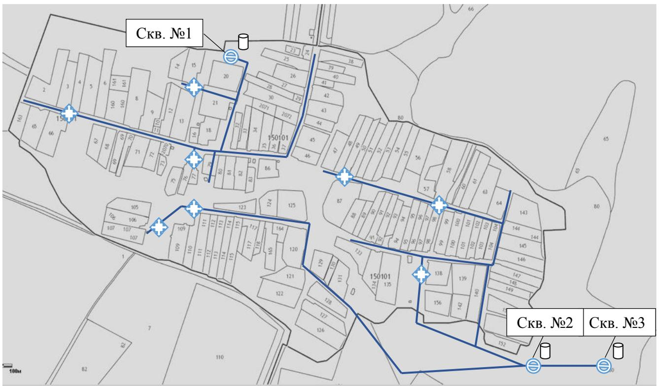
Рисунок 12 Схема водопроводной сети и источников водоснабжения с. Татарский Дюм-Дюм
