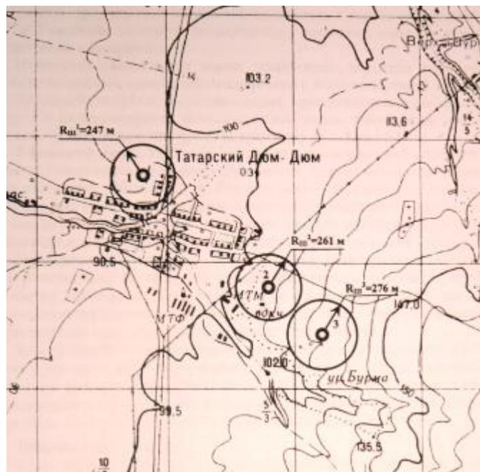
Рисунок 3. Схема расположения скважин в с. Татарский Дюм-Дюм.
