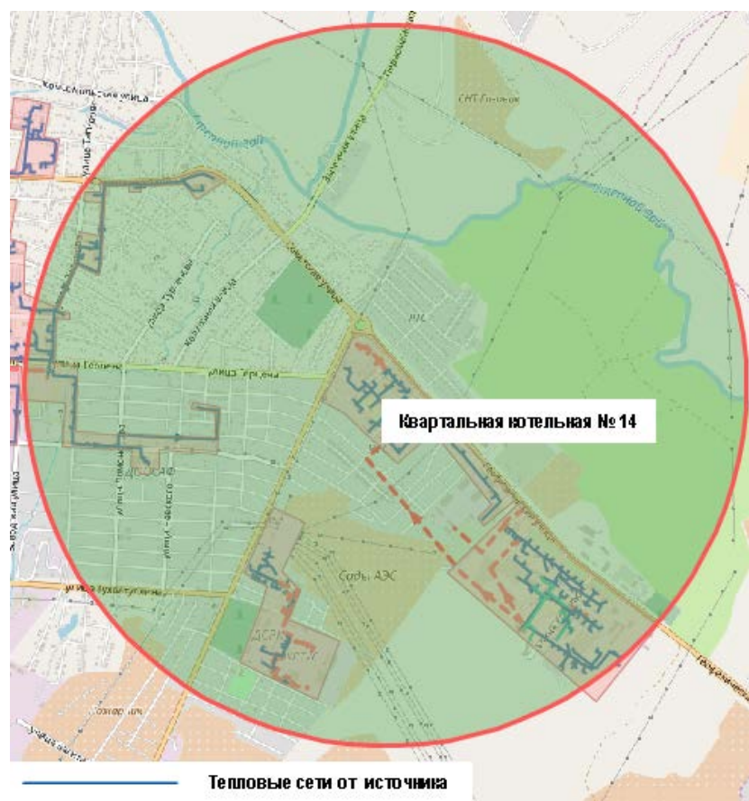
Рисунок 83 Радиус эффективного теплоснабжения квартальной котельной №14 АО АПТС
